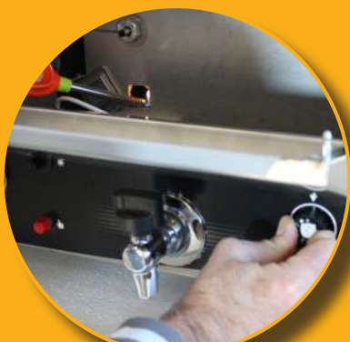
ACCENSIONE MANUALE FIAMMA PILOTA PILOT FLAME MANUAL IGNITION
